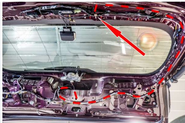
Рисунок 4 – Расположение трубки в багажном отделении
