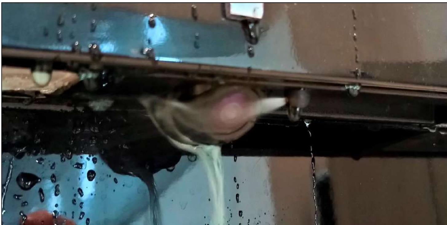
→ убедиться на экране монитора, что поток струи омывает всю поверхность линзы камеры;
