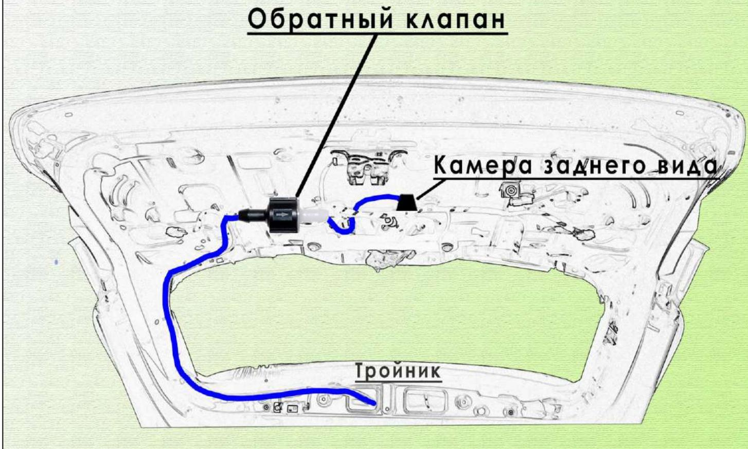
Рисунок 6. Установка обратного клапана.
