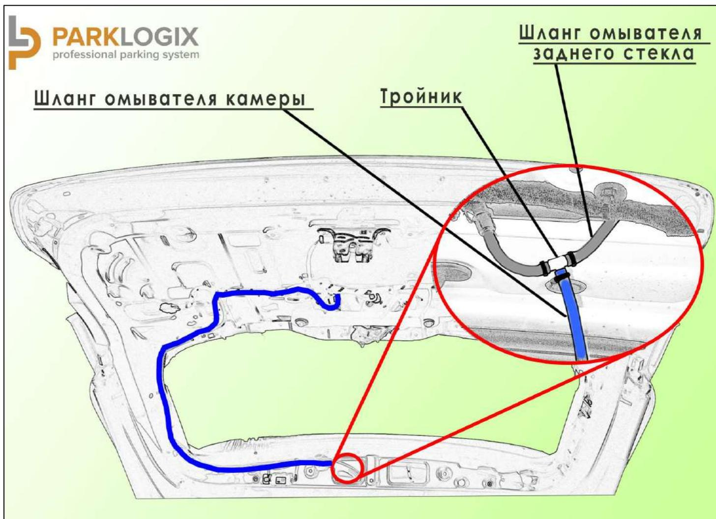
Рисунок 5. Установка тройника.
