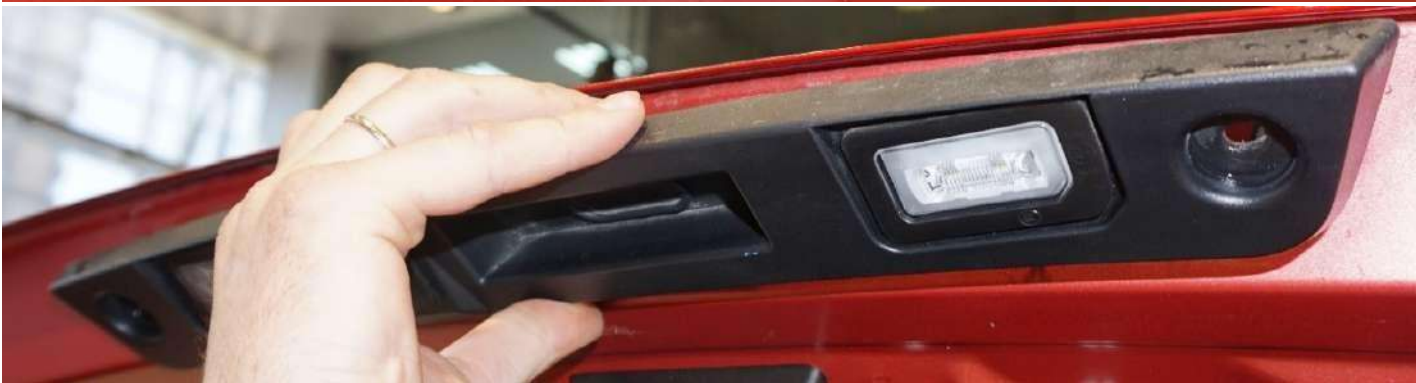
Рисунок 11 - Демонтаж наружной накладки
