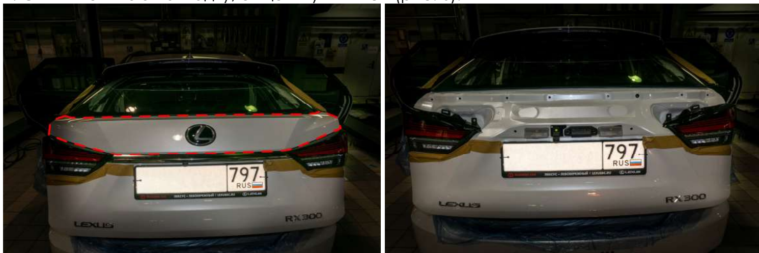
Рисунок 6 – Расположение провода питания
