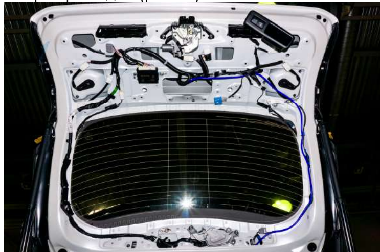
Рисунок 9 – Расположение трубки в багажном отделении
