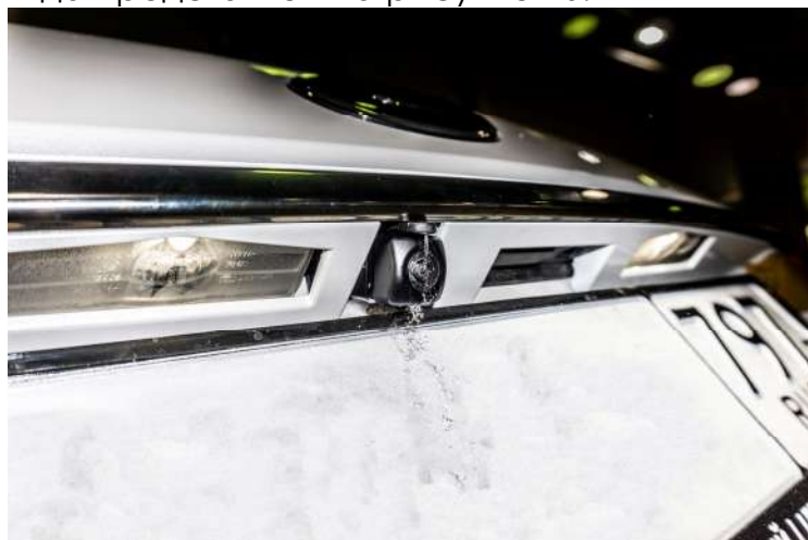
Рисунок 10 – Общий вид омывателя
