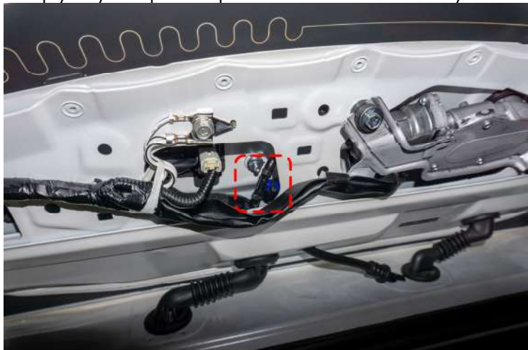
Рисунок 9 – Расположение трубки в багажном отделении
