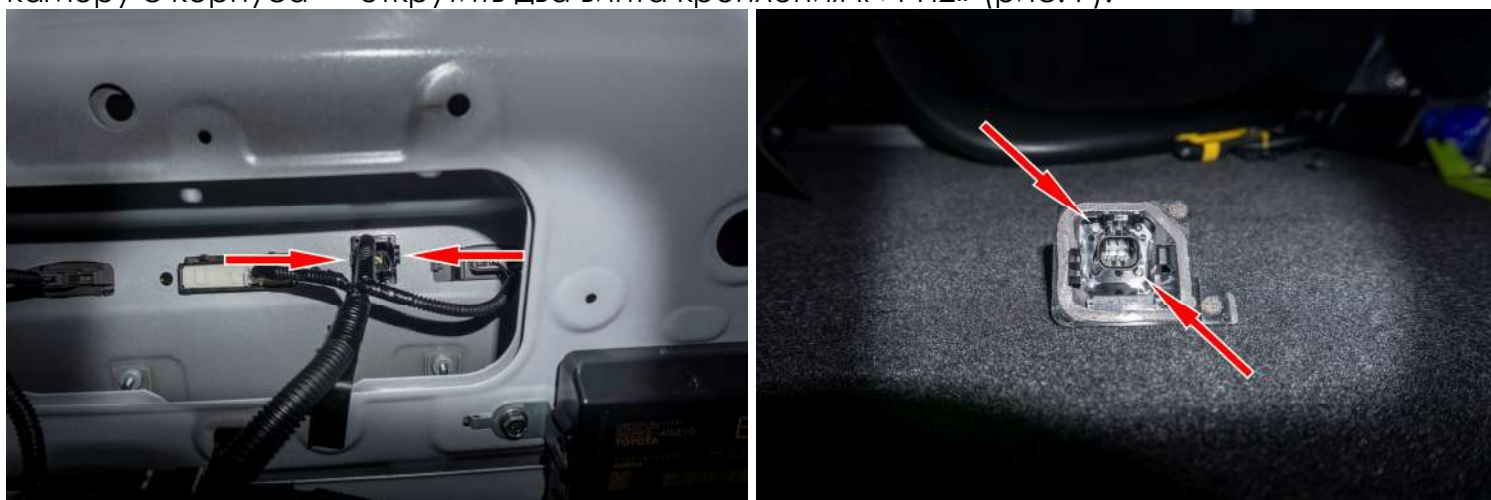
Рисунок 7 – Расположение фиксаторов корпуса камеры
