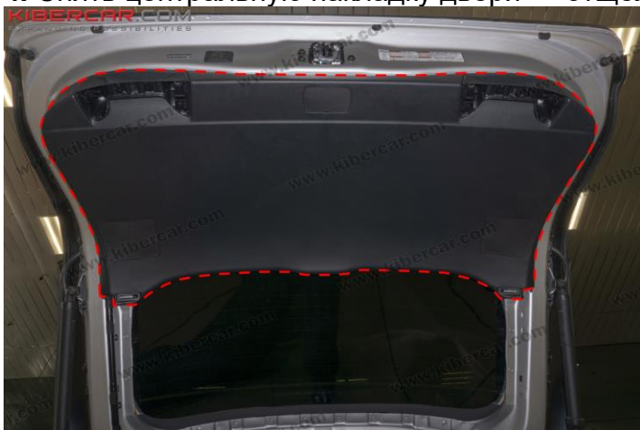
Рисунок 6 – Расположение центральной наклейки двери
