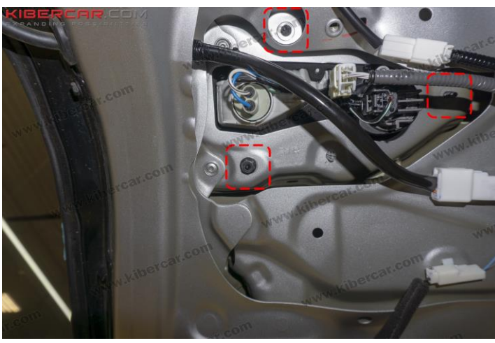
Рисунок 7 – Расположение гаек крепления
