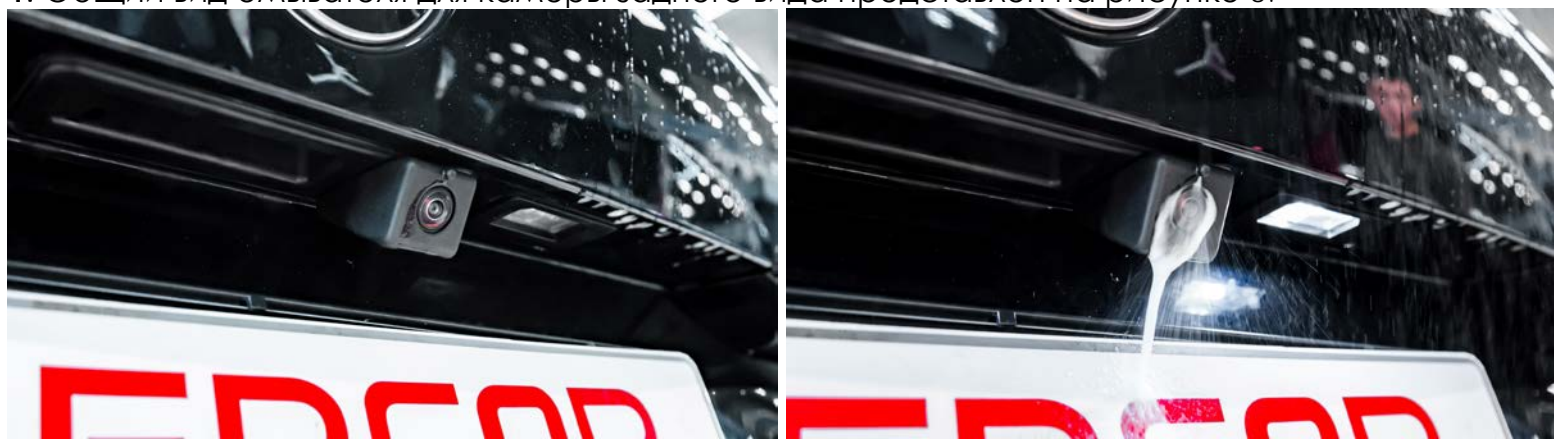
Рисунок 5 – Общий вид омывателя для камеры заднего вида
