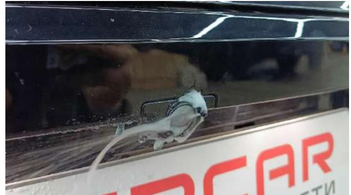
→ проверить работоспособность на экране монитора, чтобы форсунка омывала всю камеру.
