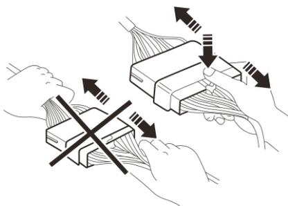
4. Во избежание повреждения компонента при отсоединении разъема ЗАПРЕЩАЕТСЯ прикладывать усилие к жгуту проводов → потяните его и нажмите на защелку (как показано на рисунке).
