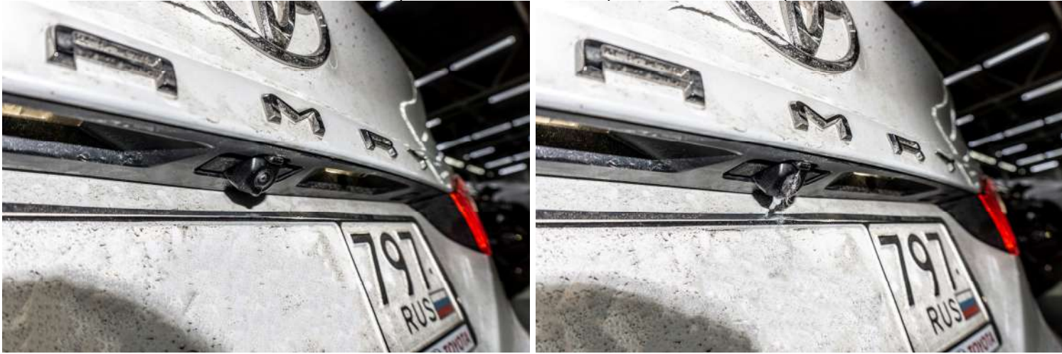
Рисунок 15 – Общий вид омывателя для камеры заднего вида
