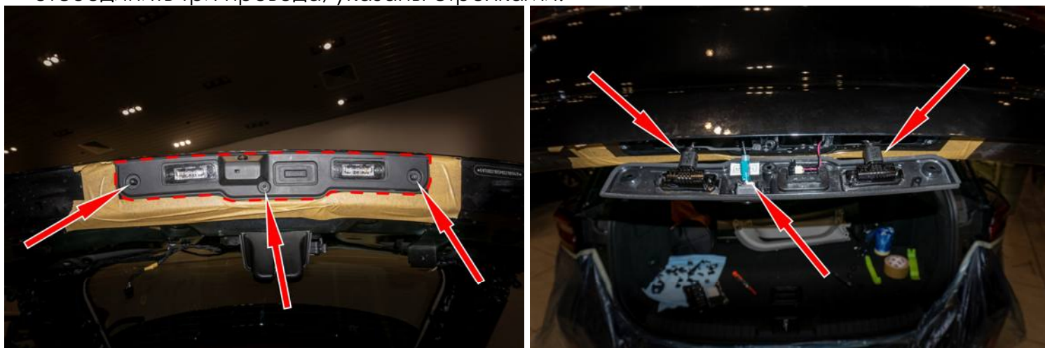
Рисунок 5 – Расположение винтов крепления внешней накладки
