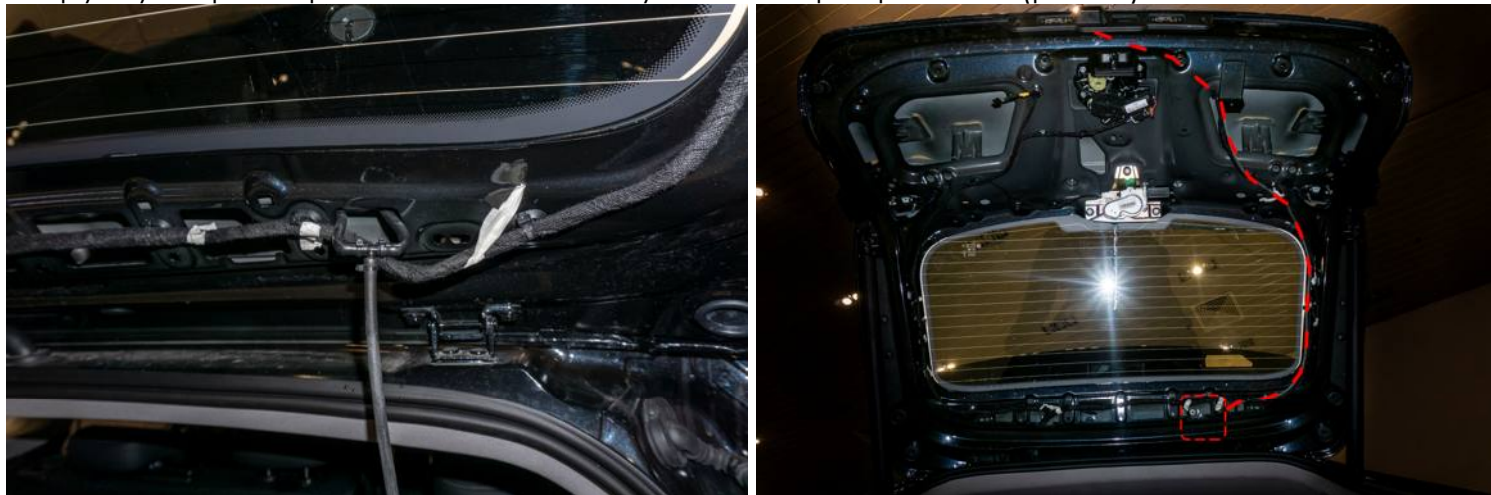
Рисунок 8 – Расположение трубки в багажном отделении
