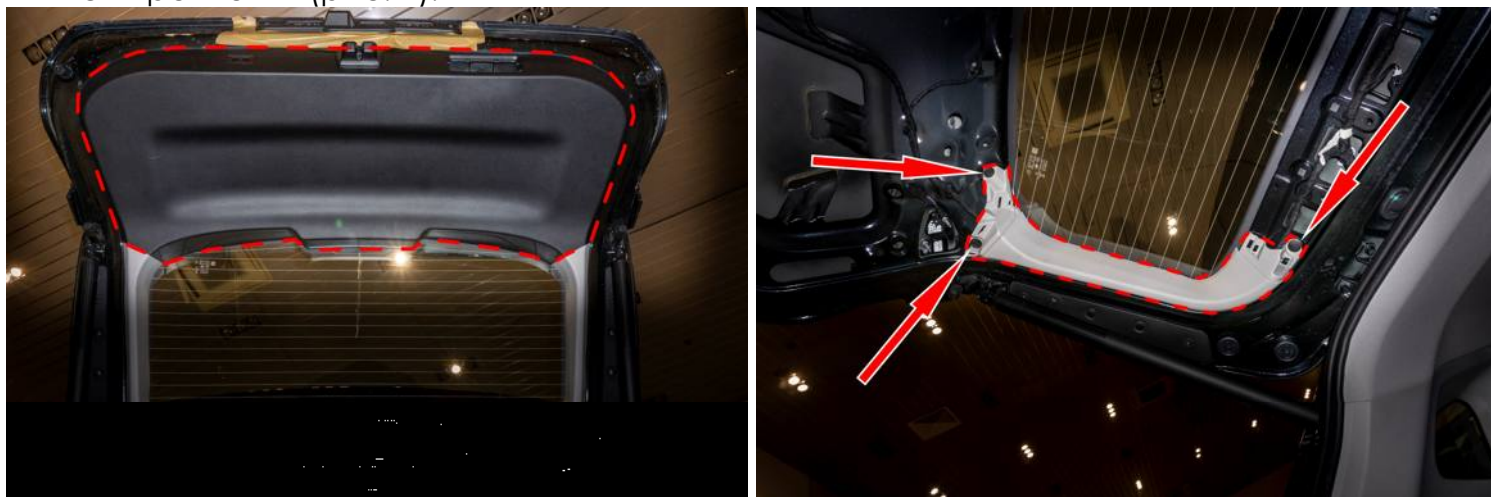
Рисунок 4 – Расположение клипс крепления
