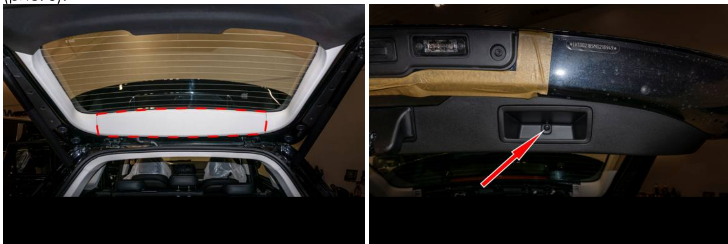
Рисунок 3 – Расположение декоративной накладки двери
