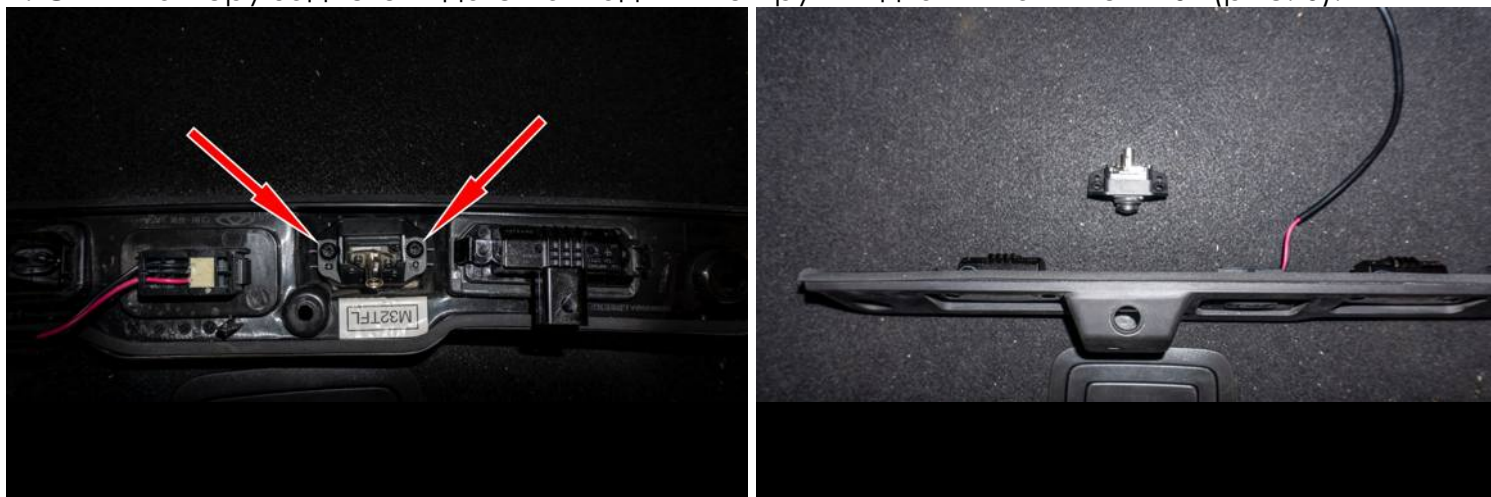
Рисунок 6 – Расположение провода питания
