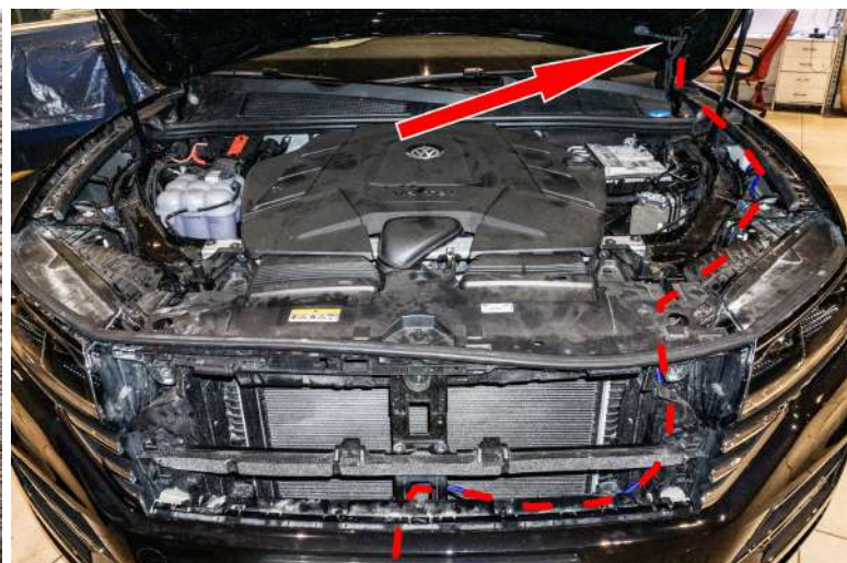
Рисунок 2 – Расположение фитинга тройника и трубки в подкапотном пространстве
