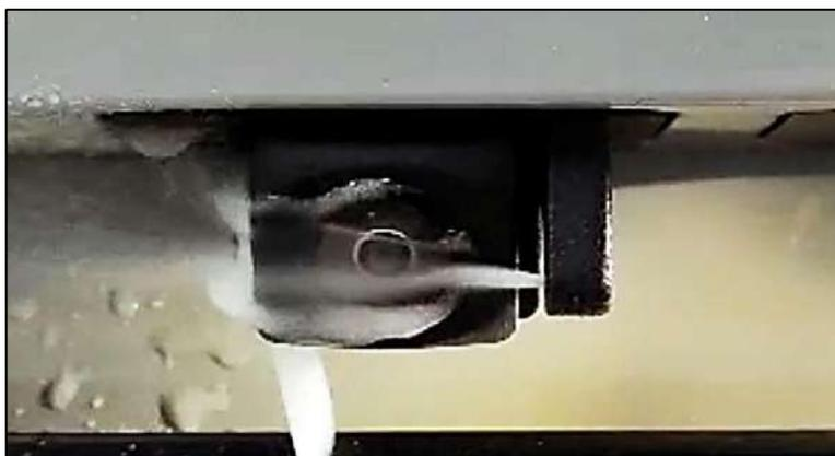
→ убедиться на экране монитора, что поток струи омывает всю поверхность линзы камеры;
