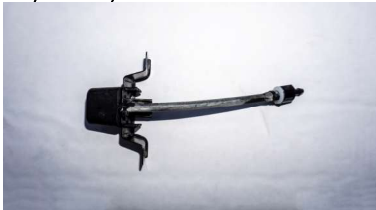
Рисунок 6 – Установка корпуса омывателя и расположение трубки
