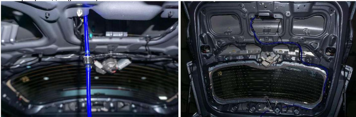
Рисунок 10 – Расположение трубки в багажном отделении
