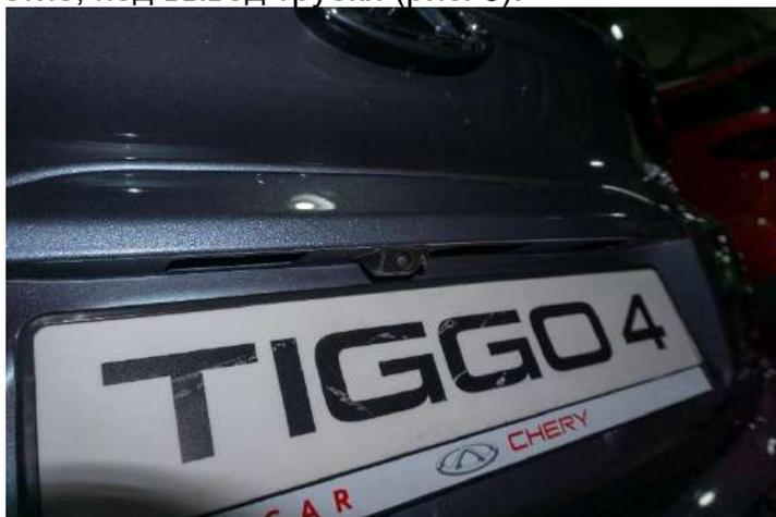
Рисунок 9 – Установка камеры в корпус омывателя
