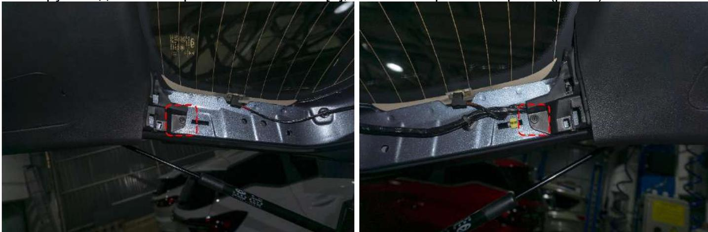
Рисунок 3 – Расположение винтов крепления
