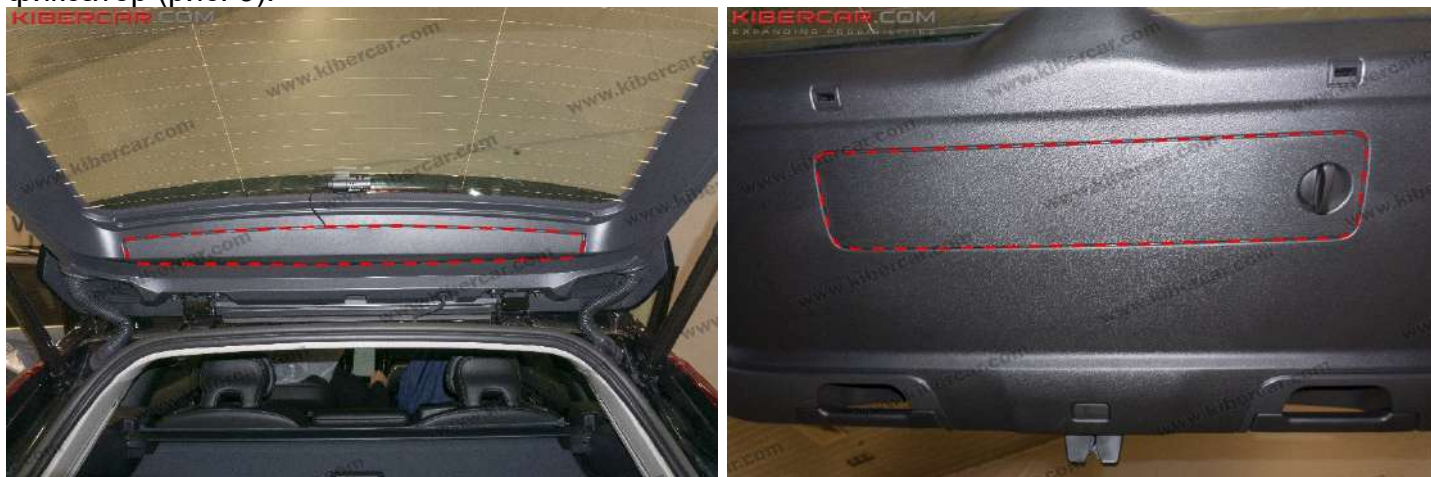
Рисунок 3 – Расположение декоративной накладки двери и отсека хранения
