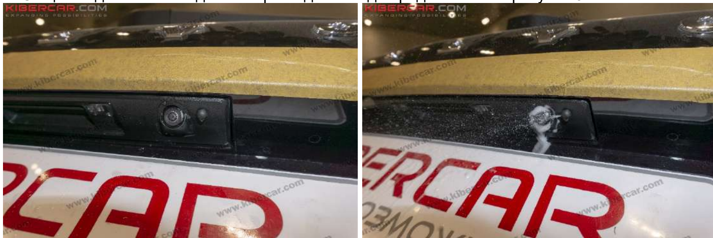
Рисунок 9 – Общий вид омывателя для камеры заднего вида
