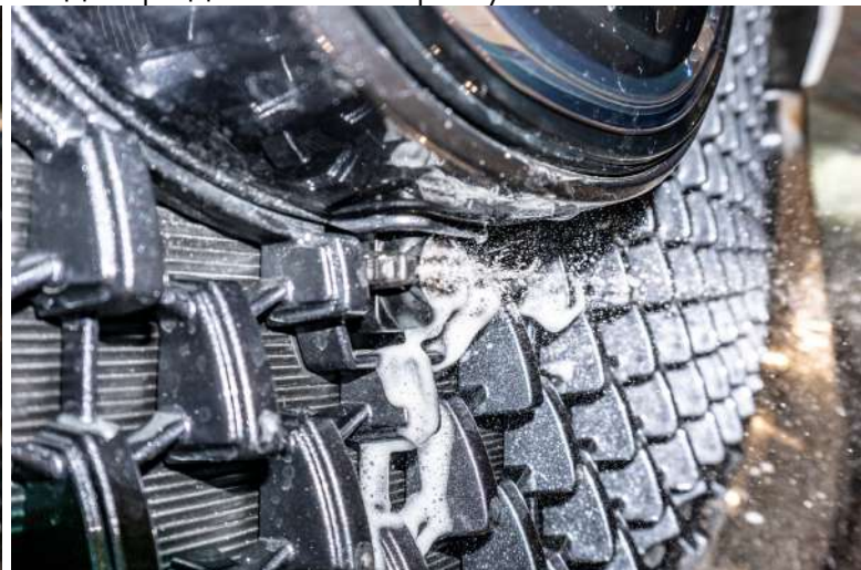
Рисунок 4 – Общий вид омывателя для камеры переднего вида
