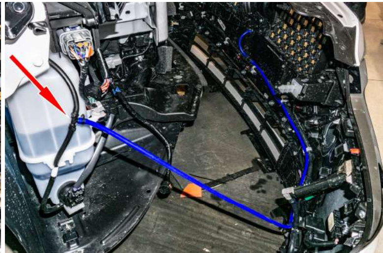
Рисунок 3 – Расположение фитинга тройника и трубки в подкапотном пространстве
