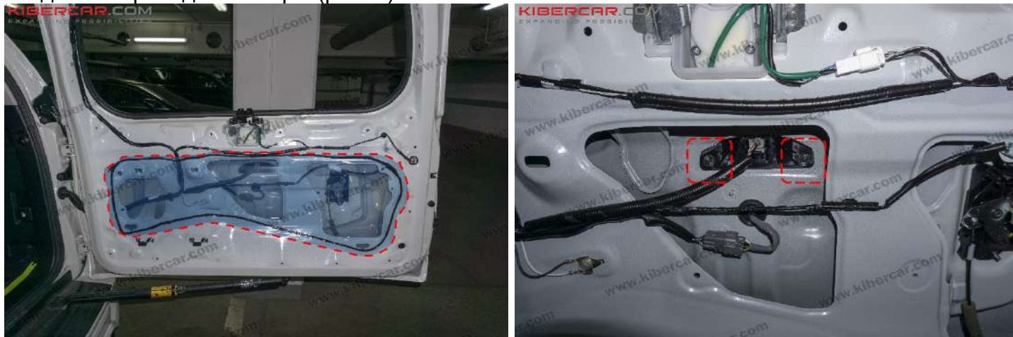
Рисунок 5 – Расположение болтов крепления корпуса задней камеры
