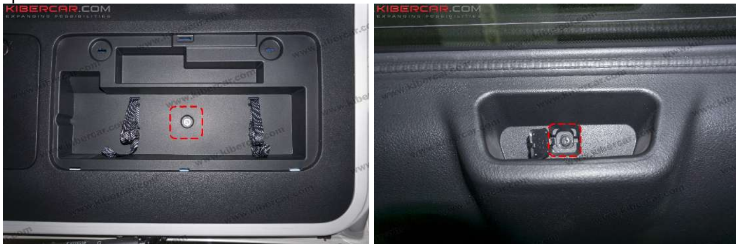
Рисунок 3 – Расположение винтов крепления центральной наклейки
