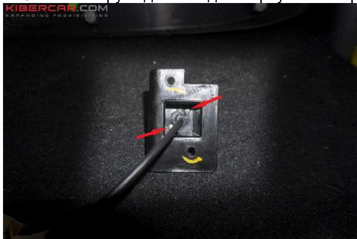
Рисунок 6 – Расположение винтов крепления
