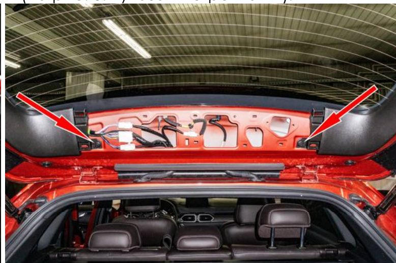
Рисунок 3 – Расположение накладок и фиксаторов
