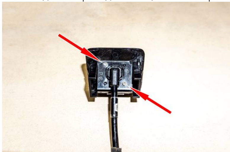
Рисунок 7 – Расположение винтов крепления
