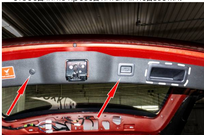
Рисунок 4 – Расположение фиксаторов крепления
