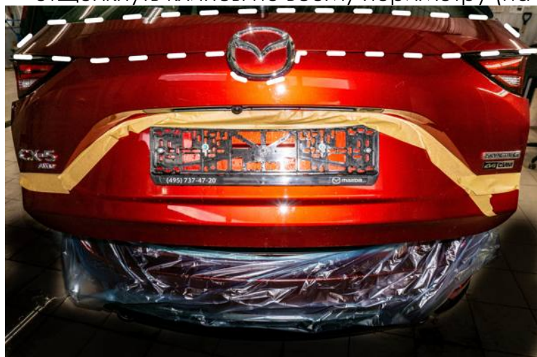
Рисунок 5 – Расположение клипс крепления
