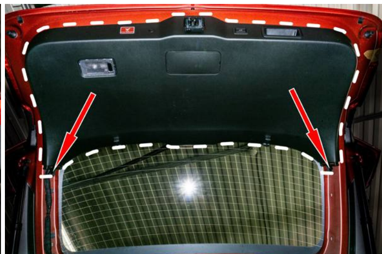
Рисунок 4 – Расположение фиксаторов крепления
