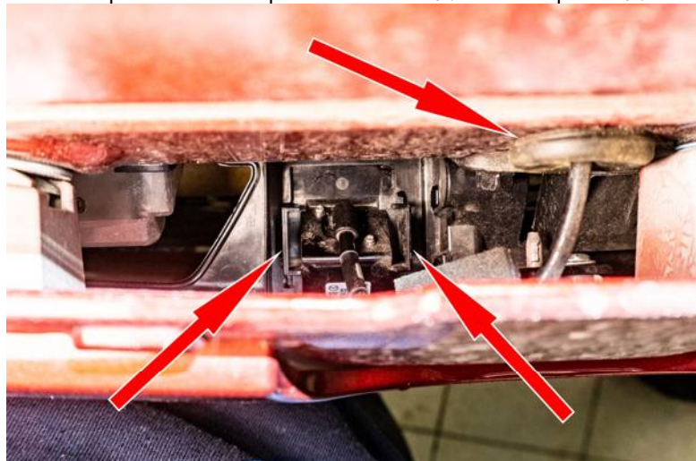
Рисунок 6 – Расположение фиксаторов и мембраны
