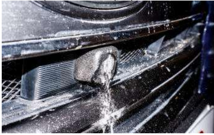
Рисунок 7 – Общий вид омывателя для камеры переднего вида
