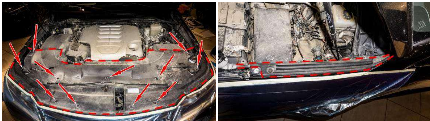
Рисунок 3 – Расположение клипс крепления
