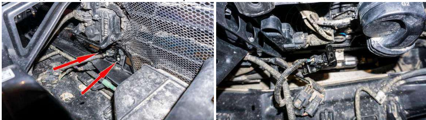
Рисунок 4 – Расположение винтов крепления корпуса
