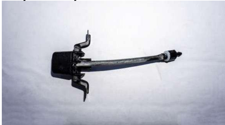
Рисунок 6 – Установка корпуса омывателя и расположение трубки
