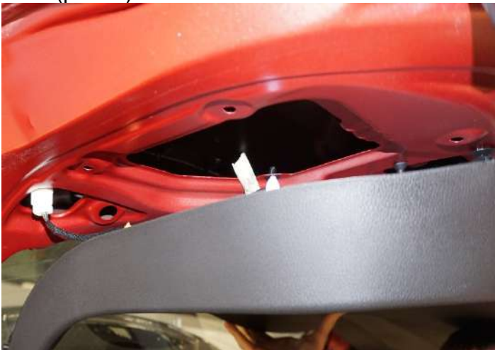
Рисунок 9 – Расположение разъема кнопки открывания багажника
