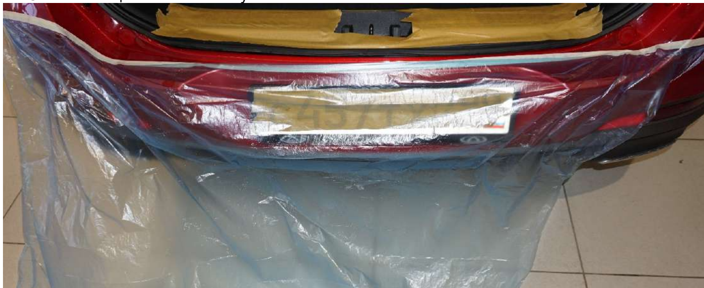
Рисунок 2 – Защита элементов салона и кузова
