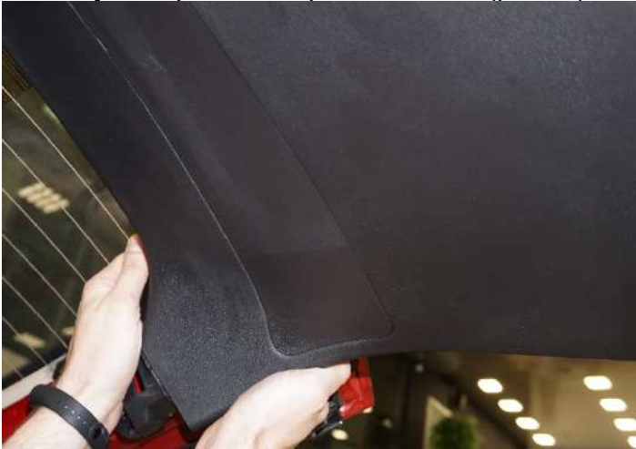
Рисунок 8 – Демонтаж центральной обивки
