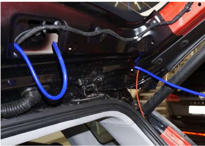
Рисунок 18 – Протяжка трубки в полости багажного отделения
