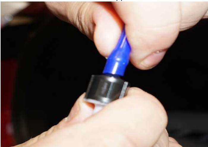
Рисунок 19 – Установка обратного клапана
