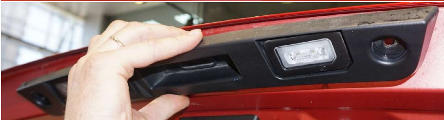
Рисунок 11 – Демонтаж наружной накладки
