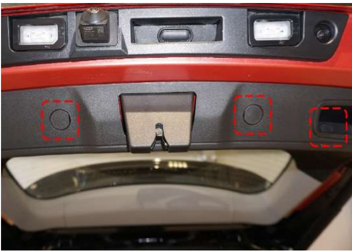
Рисунок 7 – Расположение винтов центральной обивки
