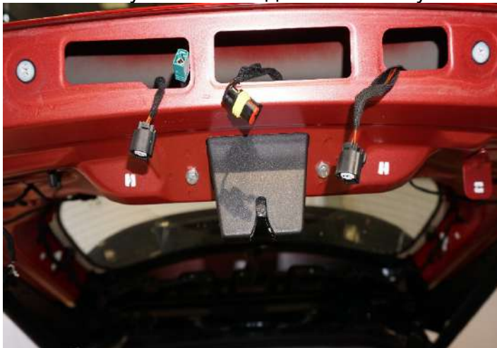
Рисунок 13 – Расположение места установки омывателя
