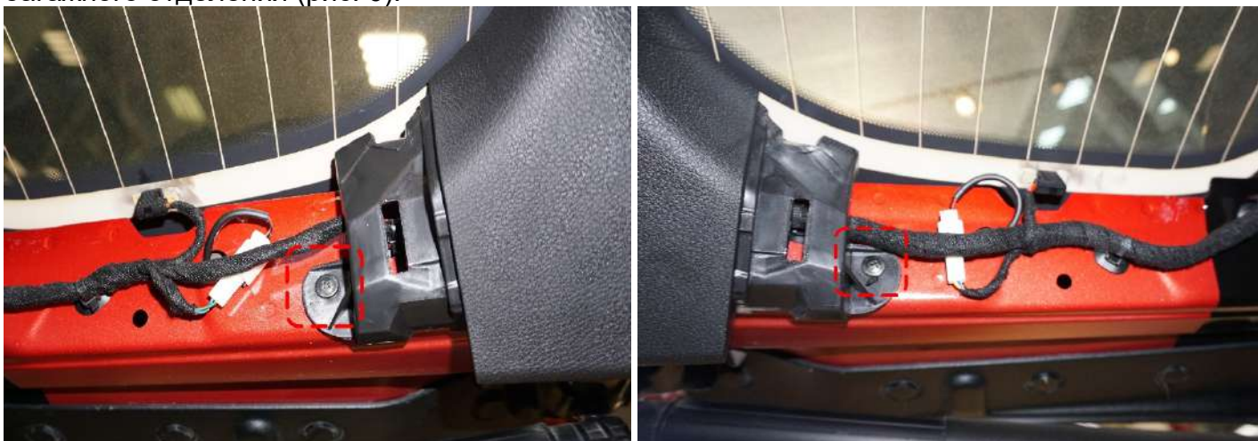
Рисунок 6 – Расположение винтов под накладками двери
