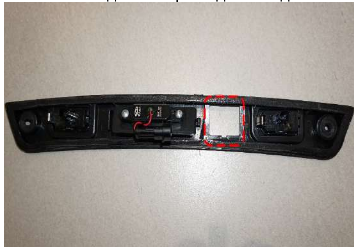
Рисунок 13 – Расположение места установки омывателя
