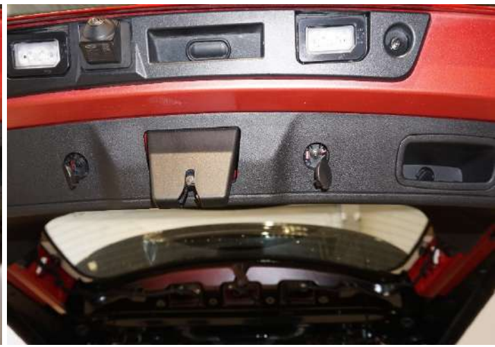
Рисунок 7 – Расположение винтов центральной обивки
