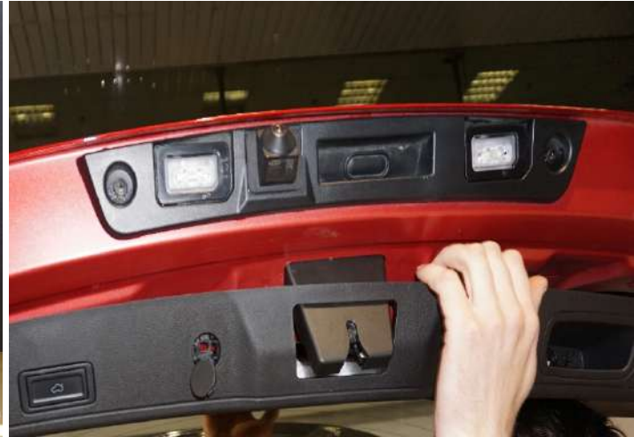
Рисунок 8 – Демонтаж центральной обивки
