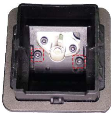
Рисунок 14 – Крепление камеры к штатному корпусу
