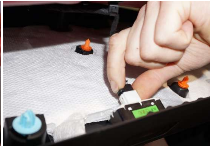
Рисунок 9 – Расположение разъема кнопки открывания багажника
