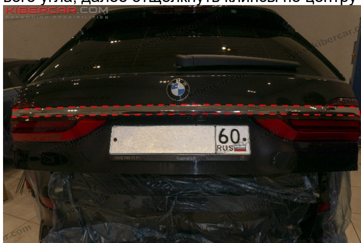
Рисунок 7 – Расположение хромированной декоративной накладки
